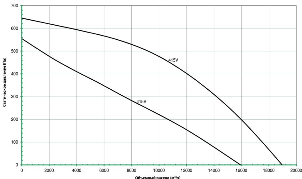
**Примите к сведению:** кривая производительности при номинальном напряжении показана при осевом воздушном потоке внутри агрегата Estoc.
