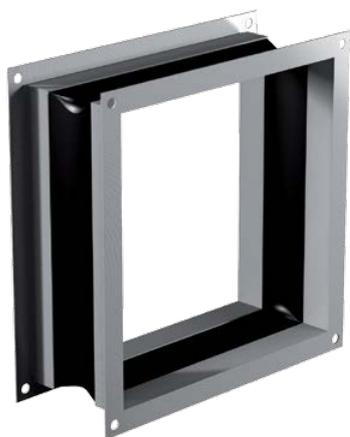
Соединения Estoc и Estoc EC SFC изготовлены из оцинкованной листовой стали. Гибкая средняя секция изготовлена из ПВХ полотна, выдерживающего температуру до +70 °С.
