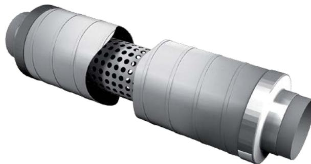
Перфорированная алюминиевая трубка с шумопоглощающим слоем толщиной 50 мм и внешним покрытием из спиральной намотки. Устанавливается напрямую в вентиляционный воздуховод или через адаптеры быстрого соединения. Подходит для применения во взрывоопасных зонах.
