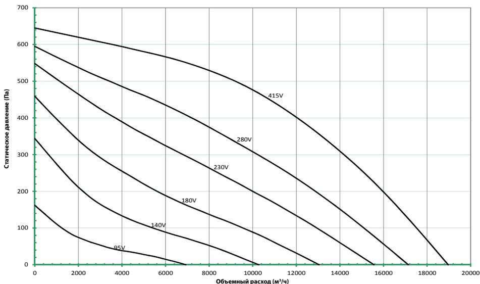
**Примите к сведению:** кривая производительности при номинальном напряжении показана при осевом воздушном потоке внутри агрегата Estoc.
