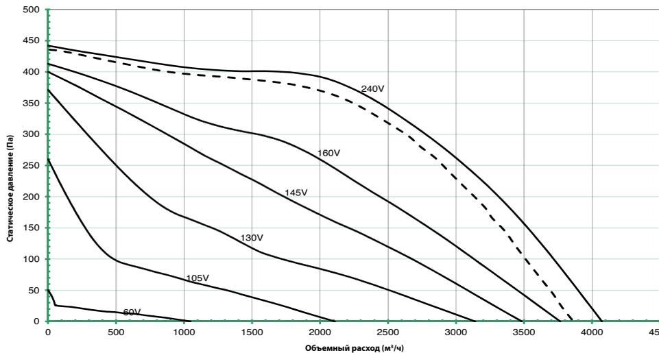
**Примите к сведению:** кривая производительности при номинальном напряжении показана при осевом воздушном потоке внутри агрегата Estoc.
