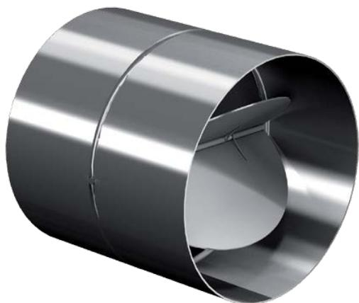
Обратный клапан изготовлен из алюминия. Открывается движением воздушного потока, закрывается с помощью «лепесткового» механизма. Корпус клапана изготовлен из оцинкованной листовой стали.
