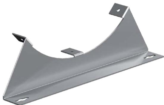
Для монтажа канального вентилятора Ropera. Изготовлена из оцинкованной стали. Отверстия совпадают с отверстиями на вентиляторе. В комплект поставки входят винты и гайки.
