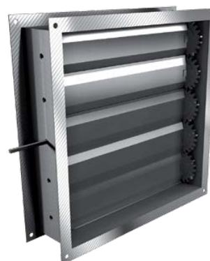
Для монтажа на Estoc. Корпус изготовлен из оцинкованной листовой стали, поворотные лопатки - из алюминия. Рычаг регулировки механизма поворотных ламелей.
