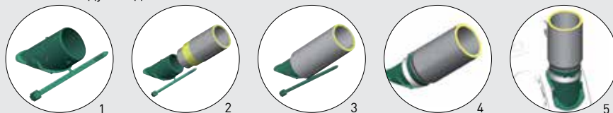
Быстрое и удобное присоединение гибких воздуховодов
