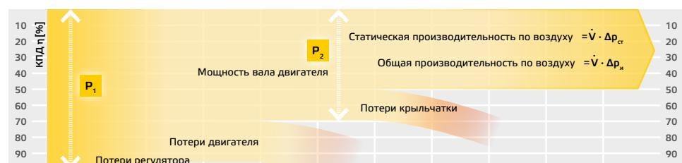
Вентилятор всегда состоит из нескольких устройств. Общий КПД рассчитывается путем умножения КПД отдельных устройств. На графике показаны различные компо-
