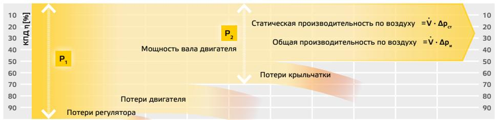
Вентилятор всегда состоит из нескольких устройств. Общий КПД рассчитывается путем умножения КПД отдельных устройств. На графике показаны различные компо-
