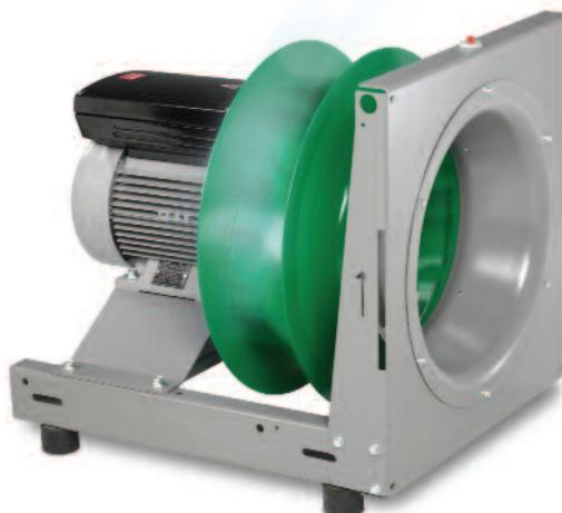
Integralmotor består av en 3-fasmotor och inbyggd frekvensomriktare. Separat motorkabel mellan frekvensomriktare och motor behövs inte då frekvensomriktare är monterad på motorn. EMC-filter är inbyggt i frekvensomriktare. Integralmotor är lämplig för fläktdrift på grund av låg ljudnivå på motorn. Integralmotor är färdigprogrammerad med motsvarande fläkt- och motorparameter. Integralmotor har skyddsklass IP55. I leveransen ingår monteringsanvisning samt parameterlista.
