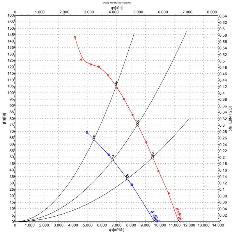
Замеры производительности соответствуют ISO 5801 категория А. Для детального уточнения способа замеров, Вам необходимо обратиться к специалистам ebm-papst. Уровень звукового давления со стороны всасывания: LwA по ISO 13347 / LpA с расстоянием 1м от оси вентилятора. Данные действительны только при указанных условиях измерения и могут варьироваться в зависимости от условий установки. При отклонении от стандартной конфигурации, необходимо проверить все значения в собранной установке.
